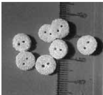
Рис. 3. Имплантат из алюмоксидной пенокерамики.
